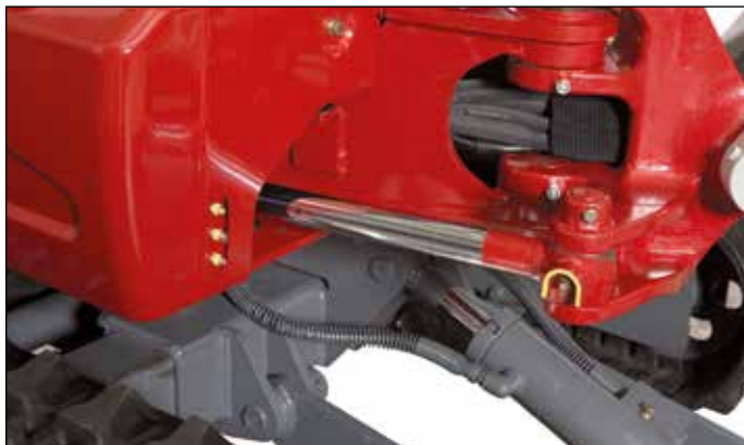
Pied de flèche robuste intégrant les conduites hydrauliques.
