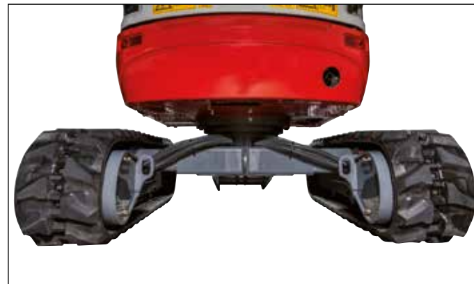
Garde au sol importante, blindage de la partie inférieure du bâti et du châssis.
