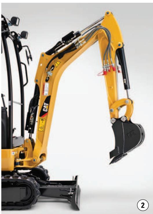
Les raccords à débranchement rapide « prêts à l'emploi » sont équipés, de série, d'un accumulateur permettant de déposer et de remplacer les outils rapidement et simplement. Situés à proximité de l'outil de travail, ils permettent d'utiliser des flexibles plus courts et de limiter ainsi les risques d'endommagement.
