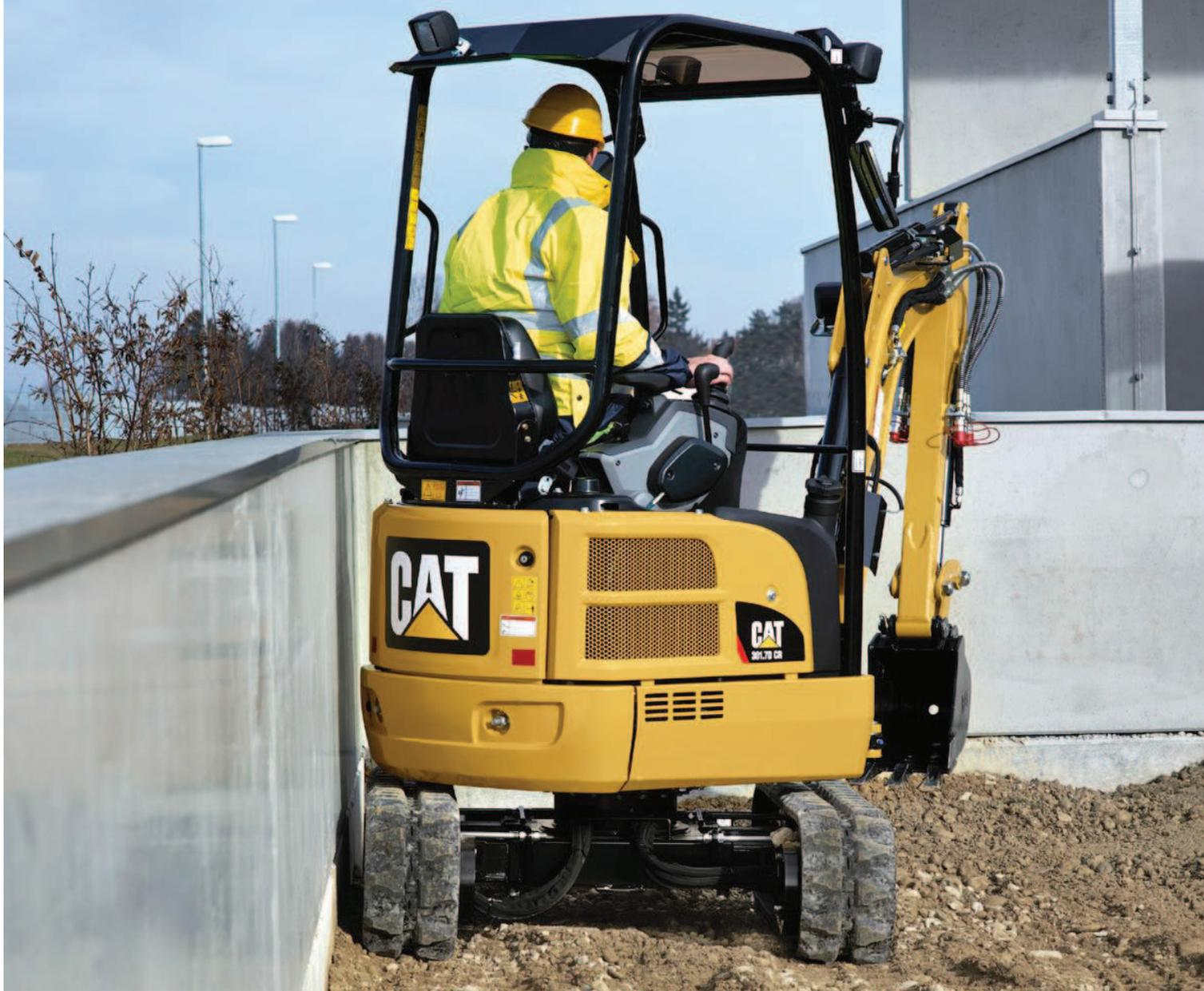
Le modèle 301.7D CR Cat à encombrement arrière nul permet de travailler confortablement dans des espaces de travail restreints. Le châssis de tourelle de la machine peut en outre pivoter sur toute sa largeur de chaîne. Cette conception à faible rayon permet de se concentrer sur les travaux à réaliser sans avoir à se soucier des dommages éventuels à l'arrière de la machine ni du reste du chantier.
