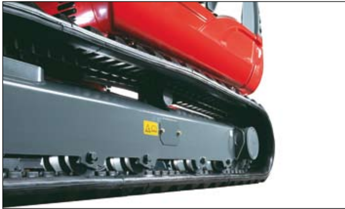
Des galets de roulement à double guidage sûr et précis des chenilles. Chaînes en caoutchouc à pas court (Short-Pitch) pour un confort d'utilisation avec peu de vibration
