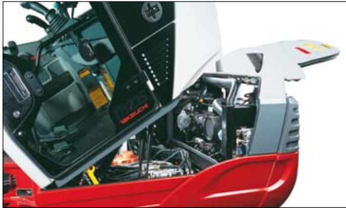
Cabine basculante pour accès optimal au moteur et à l'ensemble des composantes
