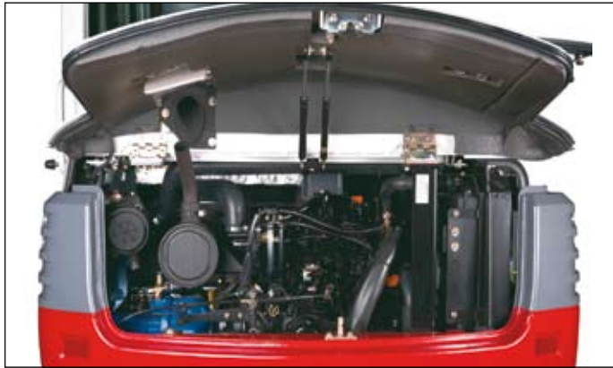
Bruit et gaz d'échappement réduits, spacieux compartiment moteur, sortie d'échappement dirigée vers le haut, contrepoids massif.
