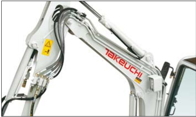
Inclus 3 circuits hydrauliques pour tous types d'accessoires. En option: un 4ème circuit
