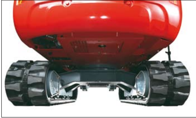
Garde au sol importante, blindage de la partie inférieure du châssis roulant
