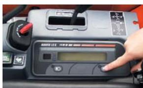
1 Insérez la clé Rouge d'enregistrement, puis pressez le bouton sur le tableau de bord.
