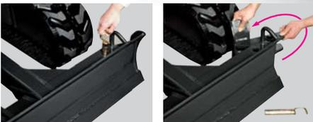
Réglez simplement et rapidement la largeur de la lame en retirant un axe pour élargir ou rétrécir la lame.
