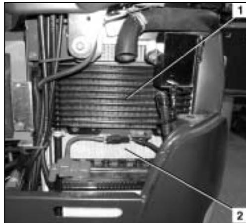
Après le nettoyage, contrôler si le radiateur / le refroidisseur d'huile n'est pas endommagé.
