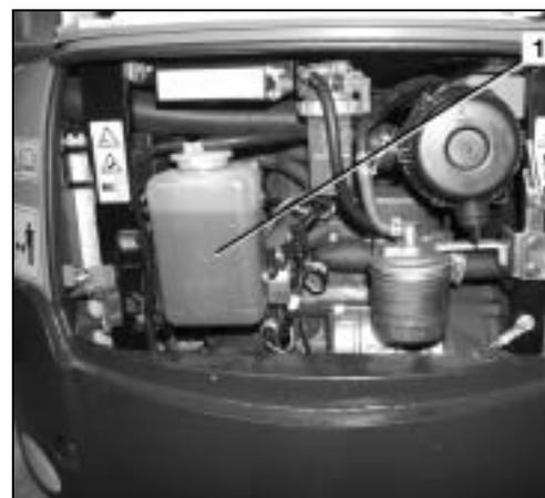
Si le vase d'expansion avait été complètement vidé, contrôler le niveau du liquide de refroidissement dans le radiateur.
